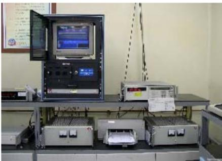
本實驗室之頻率標準為與國家標準同級之標準鉀原子鐘，為獲得TAF 認證之時頻標準實驗室，頻率標準以衛星定位系統（GPS）之方式做國際間之比對，提高準確度與穩定度；針對各類計頻器、計時器以及頻率標準器校正，提供校正各種信號類儀器之標準頻率，為三軍時頻標準之追溯源。
