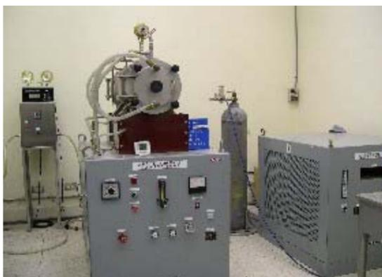
自民國七十三年起，儀校組開始籌建光高溫計校正能量，至七十六年完成，並正式對外展開校正服務，此後陸續擴充錫 (Sn)、鋅 (Zn)、鋁 (Al)、銀 (Ag) 等定點高溫爐、各式標準光高溫計、紅外線溫度計等 (範圍：50-1800°C，穩定度 1%)。儀校組完成光學濾鏡在光高溫計校正上之運用與影響之研究，本項研發成果提供各型光高溫計等儀器校正工作，並協助材料研發及特殊高溫等之測量，是相當可靠之校正方法。
