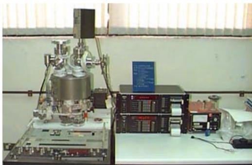
本系統包括 BALZERS PSK100S 超真空校正系統，以及游校專用真空系統 (MKS PVS6B-HA)，以高穩定之黏滯式真空計作為追溯標準，定期追溯國家標準，並以此作為軍方及國內高等級標準。由低真空至高真空，本組可進行各式真空計之校正，包含機械式、派蘭妮、熱偶式、電容式、離子式及黏滯式等真空計之校正及現場遊校。
