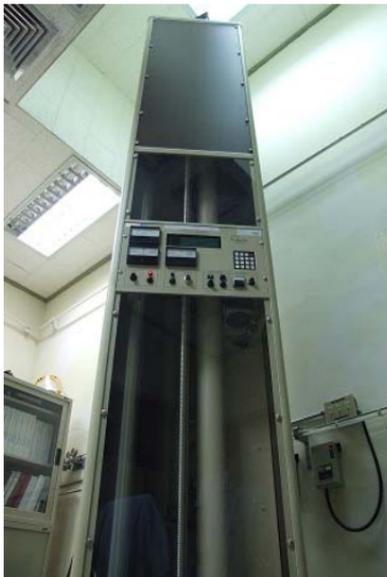
1025LX110-2C)，液/氣壓重錘式原級壓力計 (RUSKA 2400-626、RUSKA2485-802、RUSKA 2465-754 等)，提供高精度之壓力標準。並具有各式的二級標準 (如 RUSKA 7250SYS、RUSKA 6000-601 等) 以利壓力之傳遞與校正工作之執行。本系統所提供之壓力標準，可進行各式液/氣壓力錶、壓力轉換器校正，以及高度儀、空速計等之空用數據機之校正。
