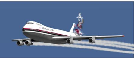
**圖二** JAL 123班機失事時尾翼毀損示意圖 (https://upload.wikimedia.org/wikipedia/commons/6/6a/747\_jal12.png)
