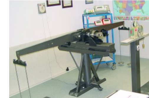
圖一 5,000 lbf ft 扭力校正設備 [Norbar官網]
