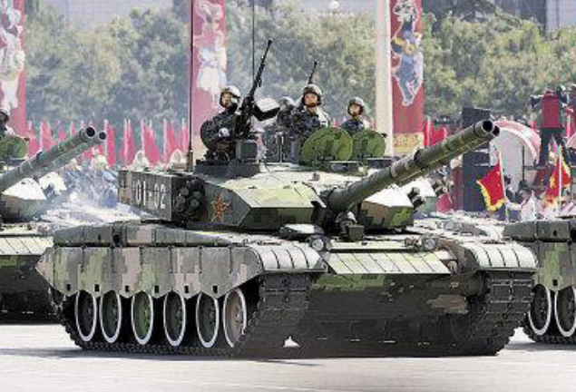
共軍新型99式主戰坦克，傳聞已裝備與俄製Shtora系統類似之干擾器（其稱為雷射致盲系統），可阻擾精準導引武器的攻擊。
