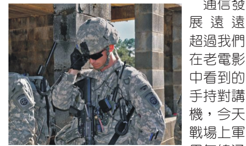
圖1、通用動力公司AN/PRC-154單兵無線電機使戰場上的士兵有保密、機動語音、視頻和數據通信功能，就如同在商業行動網路一樣方便。
